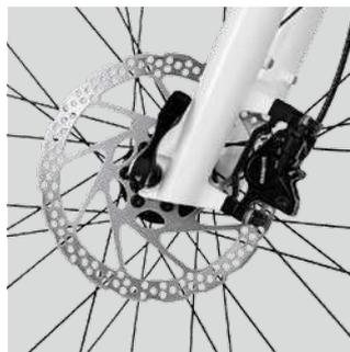
**ДИСКОВЫЕ ТОРМОЗА** Надежные гидравлические тормоза с простой дозировкой тормозного усилия подходят для любой погоды.
